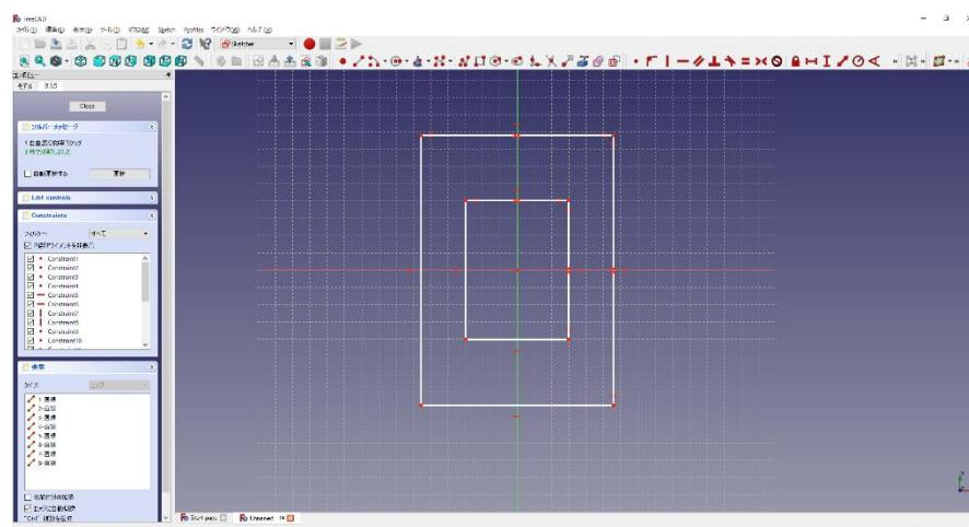
④ 四角形の寸法は図のように入力する。( H 60mm、 I 120mm、 H 30mm、 I 90mm)
