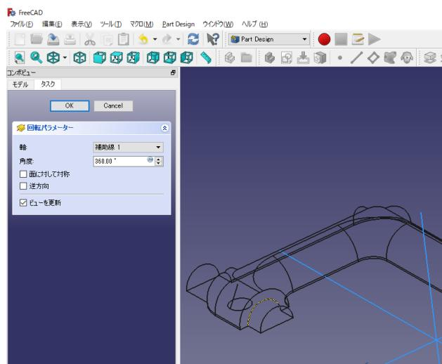
⑱ 回転パラメーターより、軸を「補助線 1」を選択し、「OK」を押す。
