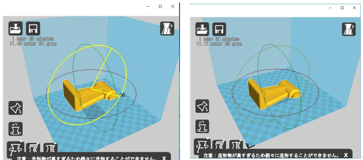
⑤ モデルの大きさを変更する（例：「縮尺」ボタンを押し X 縮尺を 0.4 にする。40%）
