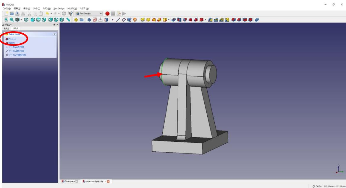
②タスク欄の表面ツールより「フィレット」を選択し、半径(4mm)を入力して「OK」を押す。
