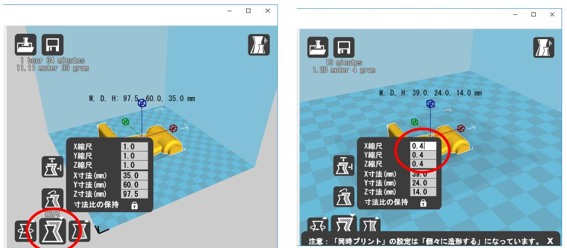
X 縮尺を設定すると Y、Z 縮尺も自動で変更される（寸法比の保持が ON の場合）
