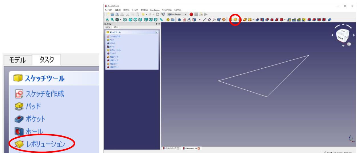
③回転パラメーターより、回転中心となる軸を選択し、回転する角度を選択して「OK」を押す。
