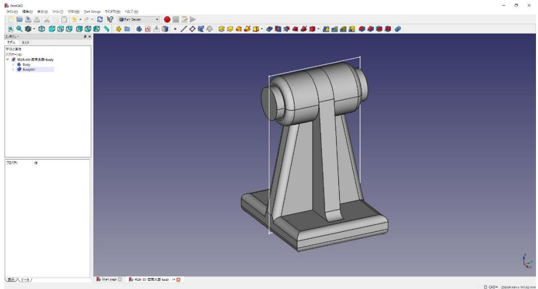
⑤タスク欄のスケッチツールより、「パッド」を選択する。パッドパラメーターより、長さを 40mm にし、「OK」を押す。
