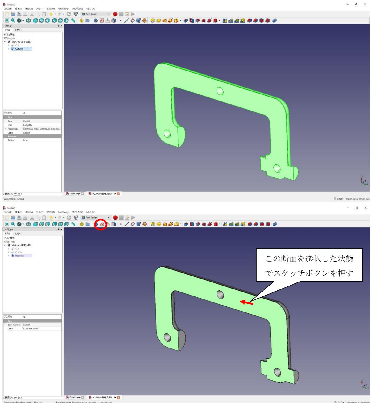
㉙ 「(8) ダボ側の図形の作成⑧～⑨」と同様に行なう。円の半径⑩ (2mm)と中心点の位置⑪ は図のように入力する。
