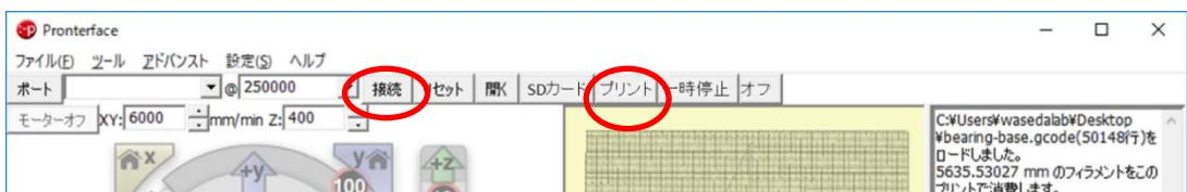
まず、テーブルが加熱され所定の温度になった後にノズルが加熱され所定の温度になった後に造形が開始される。
