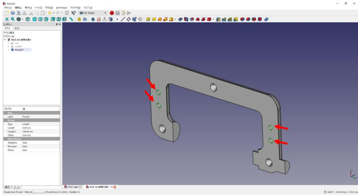
③タスク欄の表面ツールより面取り を選択し、サイズ(1mm)を入力して「OK」を押す。
