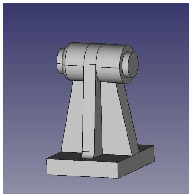
反対側も同様にフィレットを作成する。(同じフィレット半径でよい場合には、「参照を追加ボタン」をクリックした後に、エッジを選択することもできる)
