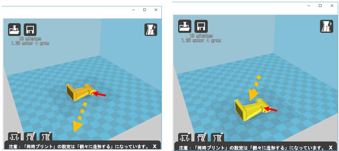
⑦ エクスポート：「G コード出力」ボタンを押し、gcode としてデスクトップに保存する(例)「bearing-stand.gcode」。必要なフィラメント量などが目安としてボタンのしたに表示されている。
