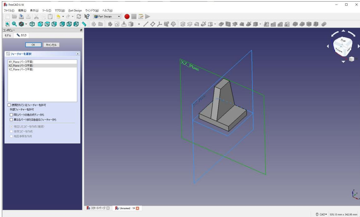
②作図中に邪魔な図形は「モデル」→描いたモデル右クリック「表示の切替え (or space キーを押す)」とすると、表示させなくできる。(例 Pad001 を選択し space キー) (再表示する場合も描いたモデルを選択し space キー)
