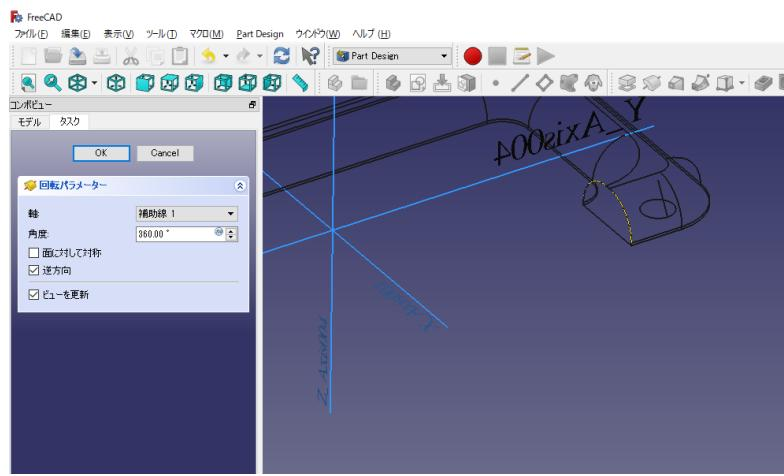
⑪回転パラメーターより、軸を「補助線 1」を選択し、「OK」を押す。
