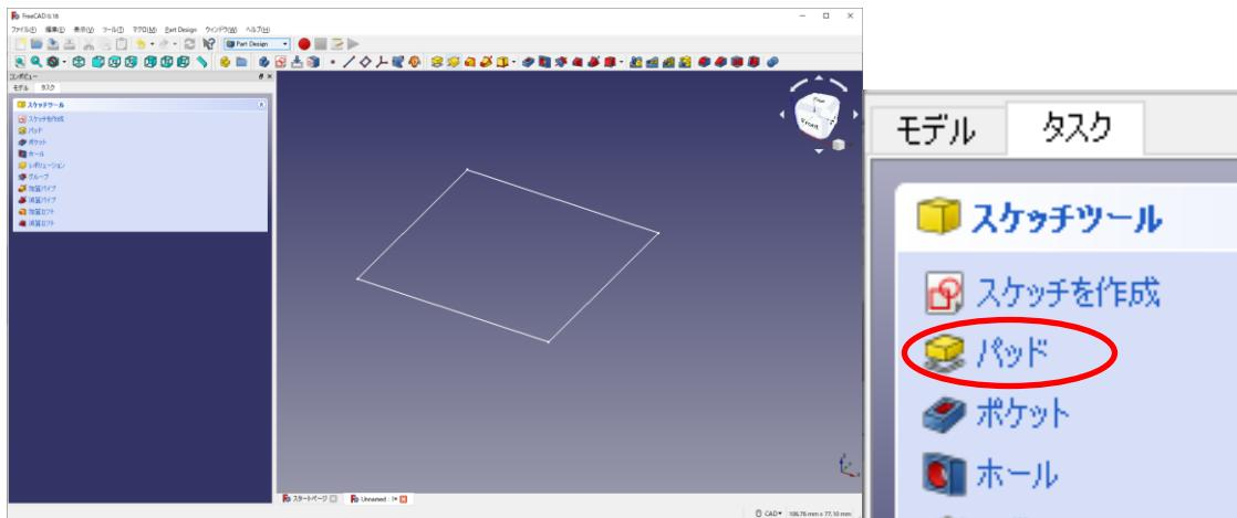
②パッドパラメーターより押し出す長さを入力し、向き等を選択して「OK」を押す。
