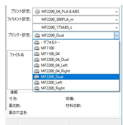
※ 後述の「プリンター設定」をデュアル（例：MF-2200D\_Dual）に設定するとフィラメント設定も2つ設定できる。
