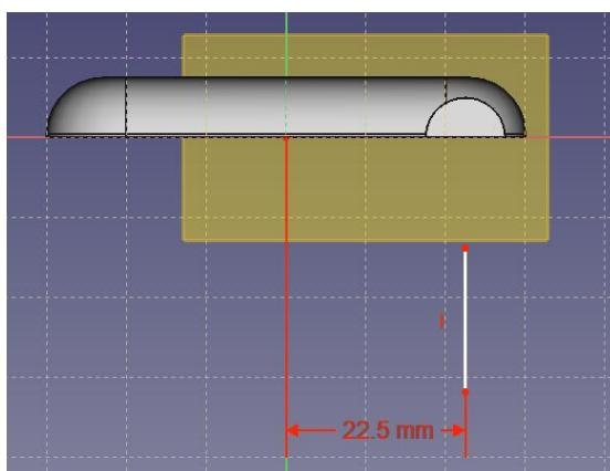
⑤直線を選択し、ツールバーから を選択して補助モードに切り替える。
