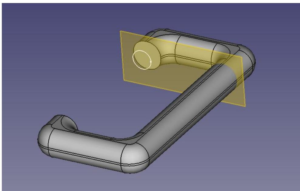
⑨ パッドパラメーターより、逆方向にチェックし、長さを 30mm（「逆方向にチェックを入れる」）と入力して「OK」を押す。
