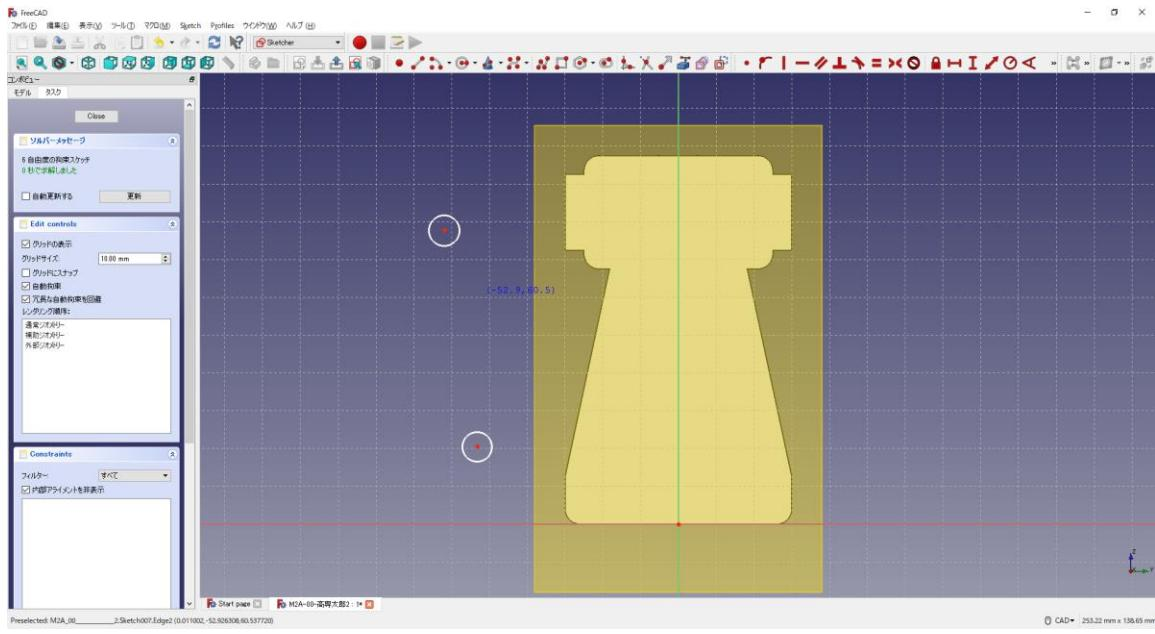
④ 2つの円の半径は同じ寸法(3mm)でそれぞれの中心点の底面からの位置 (82.5mmと6mm) は図のように入力する。
