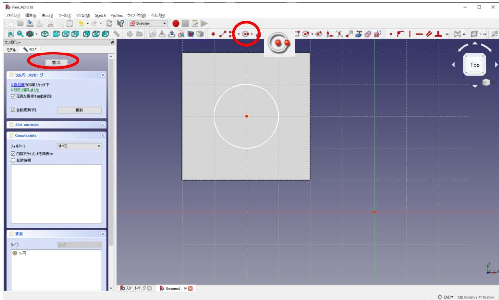
②「閉じる」を押して、タスク欄のスケッチツールより「ポケット」を押す。
