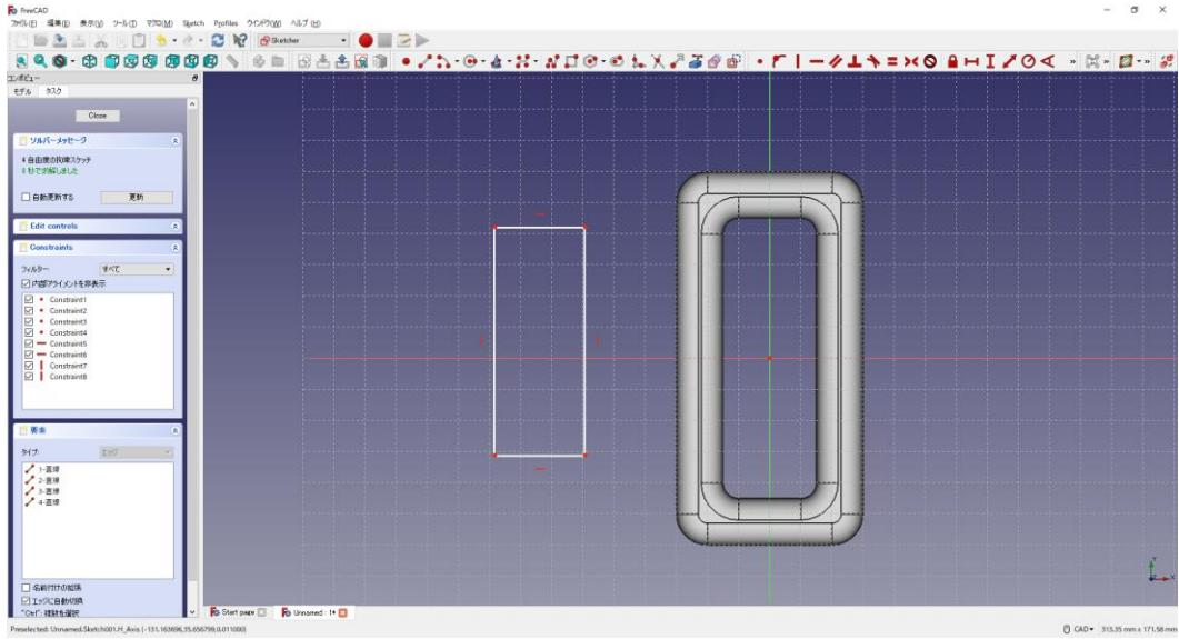
③四角形を xy 平面の中心線に対して縦方向に対称拘束 ➤➡ する。四角形の寸法は図の
