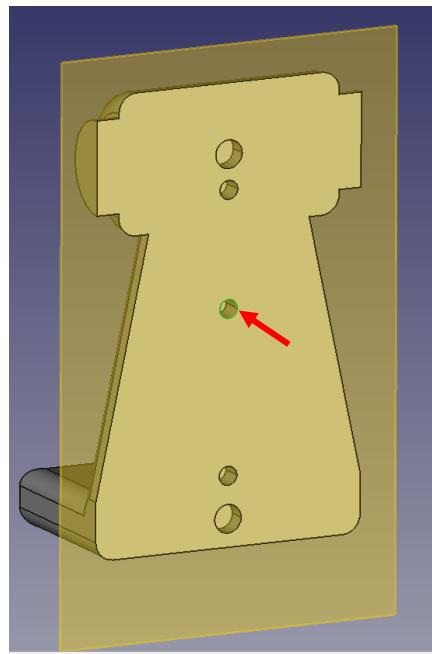
⑰ タスク欄の表面ツールより「面取り」 を選択し、サイズ(1mm)を入力して「OK」を押す。
