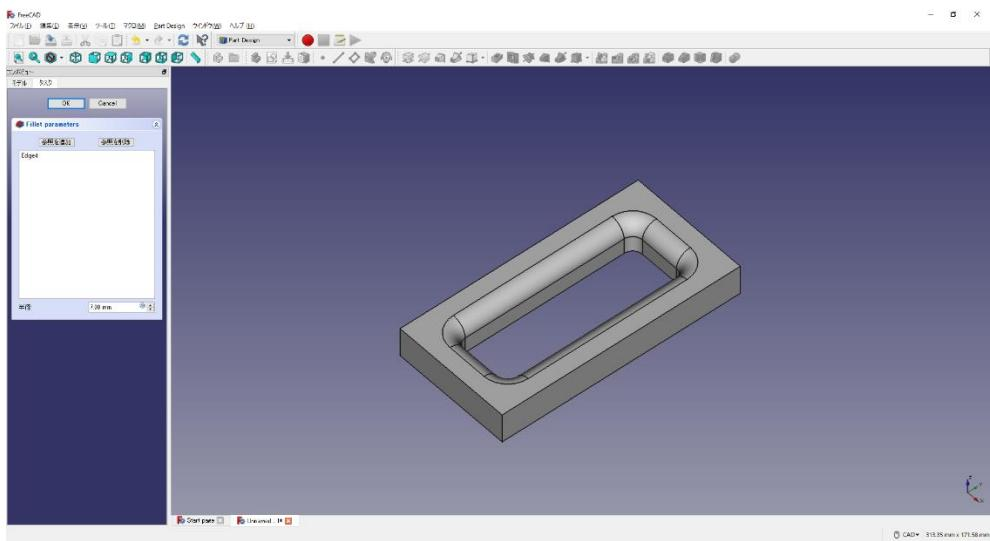
回転させ、「参照を追加ボタン」を押し、反対側も選択する。
