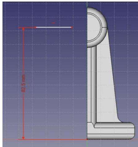
④直線を選択し、ツールバーから を選択して補助モードに切り替える。
