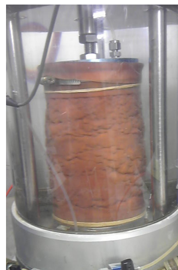
図 7 せん断終了時の供試体の外観（混合率 30%：有効拘束圧 200kPa）．
