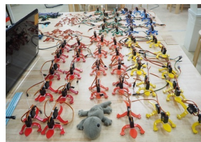
トカゲ型ロボットです。腰の曲げとひねりで移動できます。
