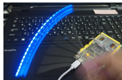
500Hzで点滅するLEDを横に振り、1/20sで撮影。
