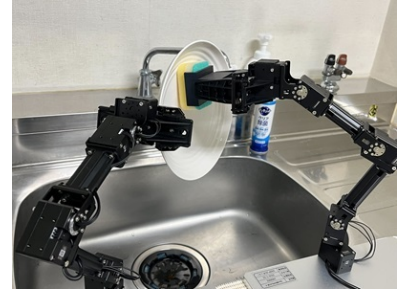
AIで自動化された双腕ロボットによる日常作業の自動化
