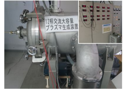
12相交流プラズマ生成装置（定格2kV, 12k VA）
