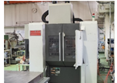
五軸工作機械では、ブレードのような複雑な形状を加工できます
