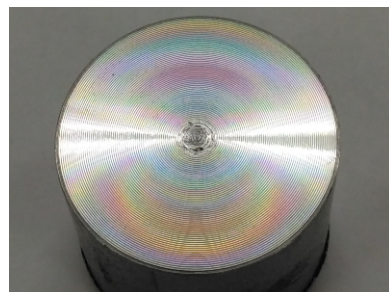
切削加工面における光の回折
