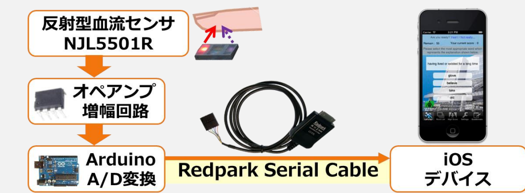
図4 脈動リアルタイムモニタシステムの構成
