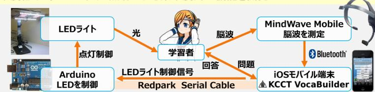
～集中度低下時LEDライト照射による集中度の変化～
