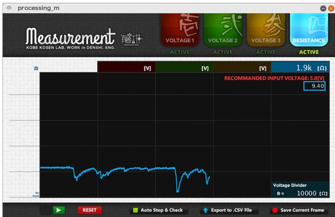
抵抗値測定機能では、計測値表示部のサイズの関係で、1000[ $\Omega$ ]以上になると「k  $\rightarrow$   $10^3$ 」、1000[k $\Omega$ ]以上になると「M  $\rightarrow$   $10^6$ 」と省略表示されます。たとえば、測定結果が3400[ $\Omega$ ]のとき、3400と表示されるのではなく、3.4kと表示されます。
