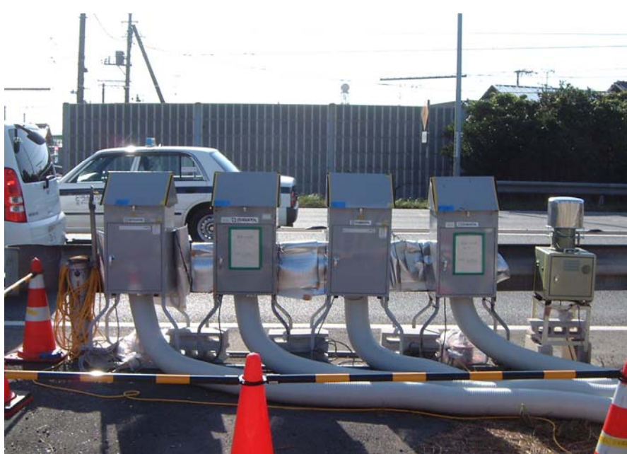
【道路沿道における自動車排出粒子の粒径別捕集風景(写真左)および捕集粒子(写真右)】
