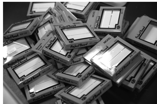
写真-2：アンプ作成用のブレッドボード。
