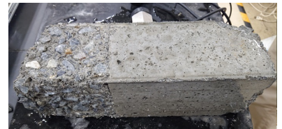
凍害を受けたコンクリート供試体
