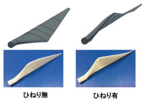
図 4. QBlade を用いて設計した 3D データと製作物 上側：QBlade を用いて設計した 3D データ 下側：3D データを基に 3D プリンタで製作したもの
