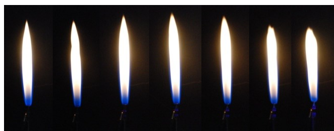
Normal 3.8kV 5kV 6kV 7kV 8kV 9kV
