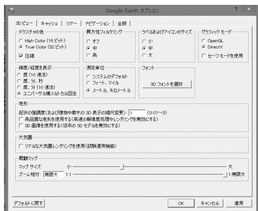
図7 緯度経度表示をUTM座標の表示に変換する
