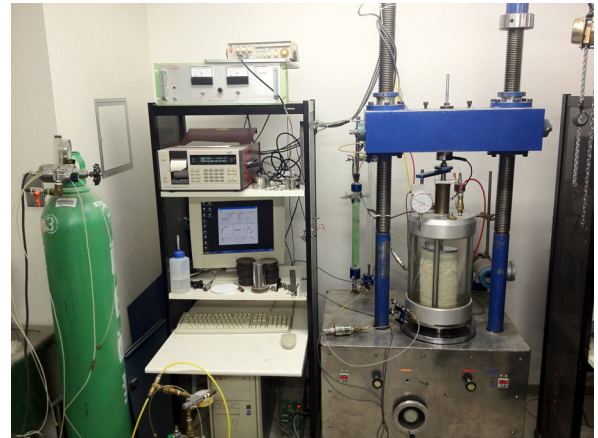
図 5 三軸圧縮試験機。
