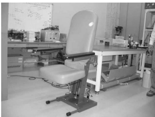
図4 新方式リニア駆動ユニットを応用した立ち上がり補助座椅子
