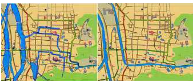
流路改修前 流路改修後 図 9 流路改修前後の図
