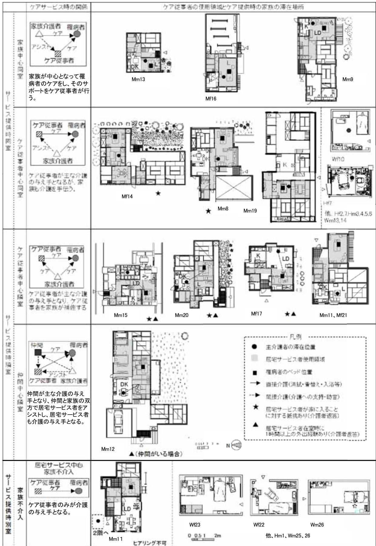
図2 ケア従事者の使用領域と家族の滞り場所およびその関係
